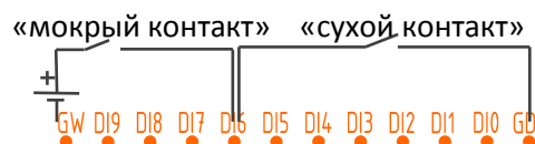
Рис.1 Схема подключения различных источников сигнала к модулю.
